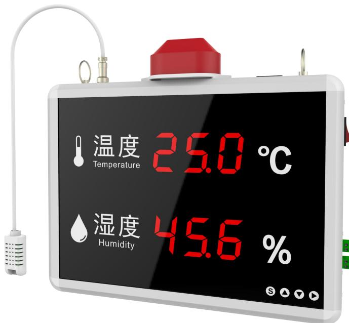
本产品为温湿度显示屏，壁挂安装方式，提供内置和外置探头两种型号，实时采集环境温度和湿度参数，实时数据显示，可选配报警灯、报警继电器或 RS485 通讯接口，通讯协议采用标准 Modbus RTU 协议。
